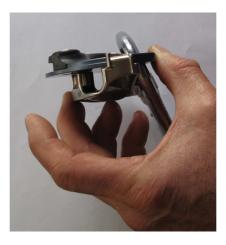
Ensuite, dans certaines configurations, si l'on ne prend pas garde à maintenir l'appareil dans la bonne position, la force de frottement tend même à le maintenir ouvert (grimpeur chutant sur la gauche de l'assureur).
